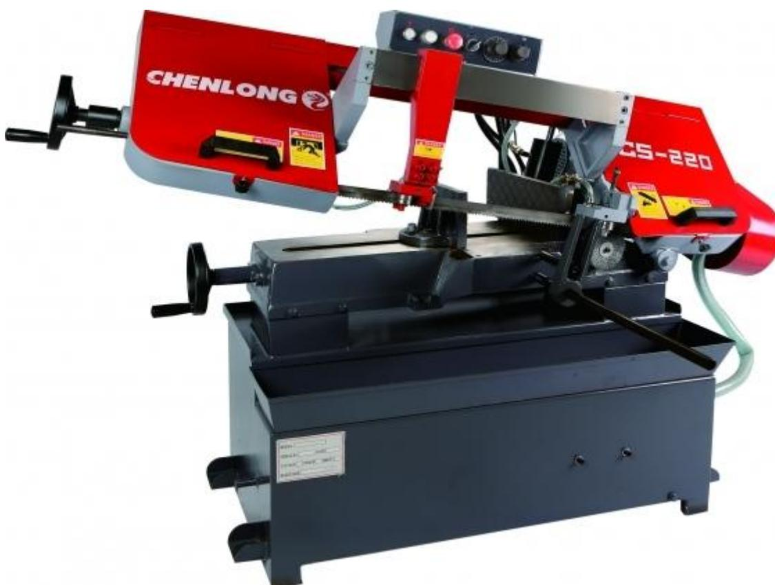
Станок ленточнопильный используется для резки различных цветных, черных металлов и сплавов. Имеет наклонную раму.
