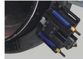
轨迹追踪刀架，针对管径变形、椭圆管道加工
