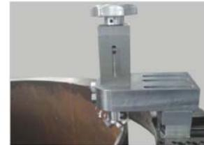
内坡口刀架，完成管道内壁坡口加工
