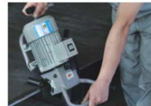
可加工平板或弯曲的工作，中凹线最小半径为55 mm；
