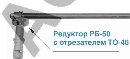
Следует учитывать, что величина крутящего момента, который необходимо прикладывать при отрезке, в значительной мере зависит от типоразмера и материала труб (так, например, для латунных труб 16x1 мм  $M_{кр.}=0,5$  кгм, а для труб из углеродистой стали 51x3 мм  $M_{кр.}=10-12$  кгм).
