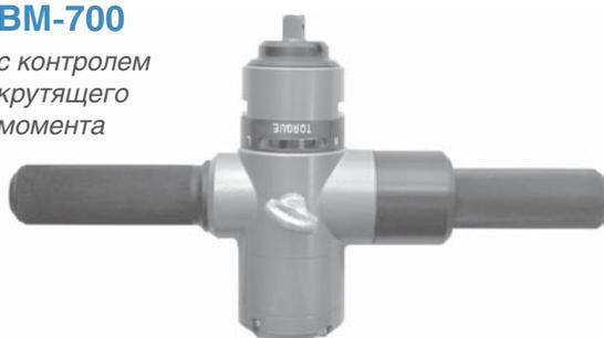
Применяется для развальцовки труб из цветных сплавов от 16х1 мм до 25х1 мм и стальных труб от 12х1 мм до 20х2 мм.
